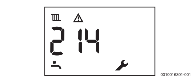
Rys. 69 Przykład: usterka niepowodująca blokady
